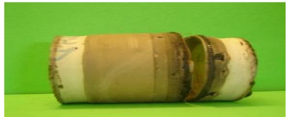
Zur Reparatur vom Kunden eingesandter Dichtkopf mit defekter Membrane
