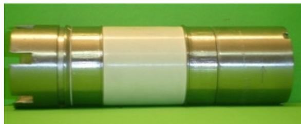
Der von Contecma überholte Dichtkopf mit neu aufgespresster EPDM-Membrane
