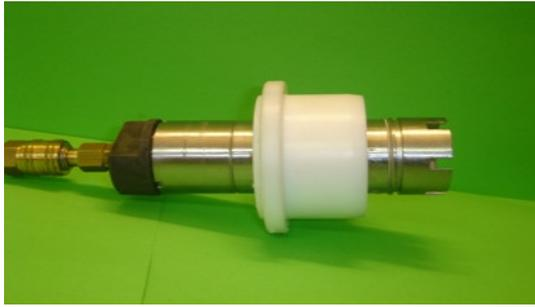
**Dichtigkeitsprüfung eines überholten Dichtkopfes**
