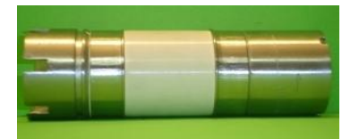
Dichtkopf mit reparierter Membrane
