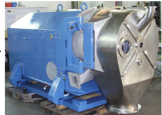
Alle Edelstahlteile sind gebeizt und geschliffen
