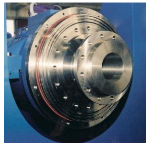
Austausch einer Wellenführung
