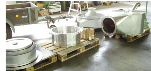
Alle Edelstahlteile sind gebeizt und geschliffen
