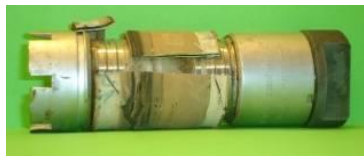
Dichtkopf mit defekter Membrane
