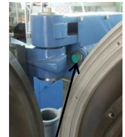
Grenzschalter Filtratgehäuse geschlossen
