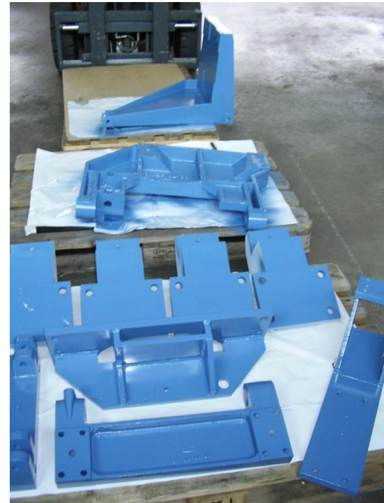
Alle Stahlteile neu lackiert
