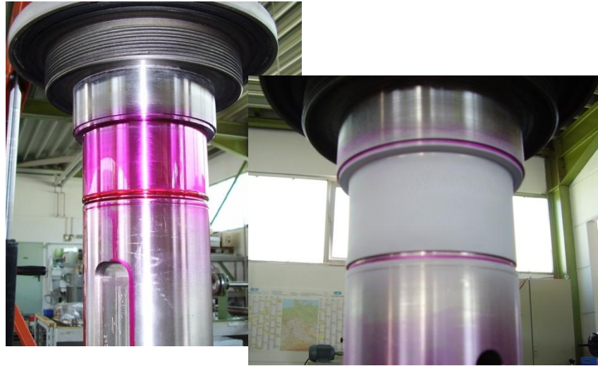
Rissprüfung nach Farbeindringverfahren
